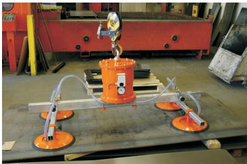
**VAKUOVÉ SAMOPŘÍSAVNÉ MANIPULÁTORY JSOU URČENY PRO HORIZONTÁLNÍ PŘEMIŠŤOVÁNÍ PLOCHÝCH BŘEMEN S NEPRODYŠNÝMI POVRCHY.**
